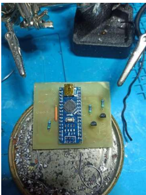
Рисунок 7 Лужение дорожек и монтаж платы
