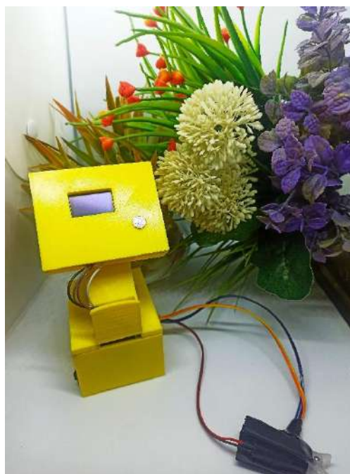
Рисунок 10 Окончательная сборка детского пульсоксиметра
