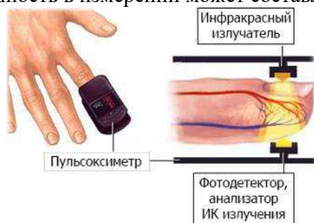
Рисунок 2 Принцип работы пульсоксиметра
