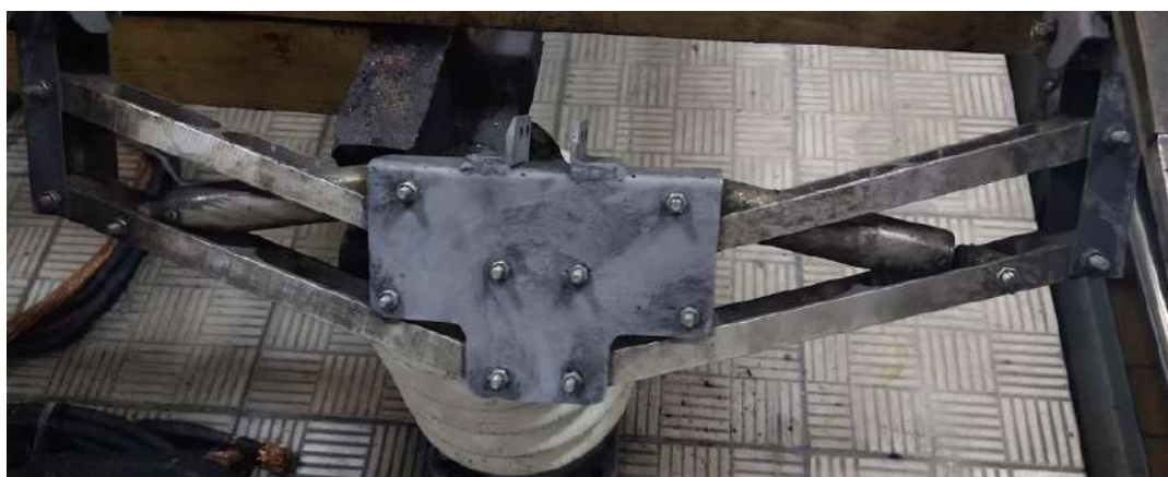
Рис. 2. Каретка рычажной конструкции токоприёмника АИСТ
