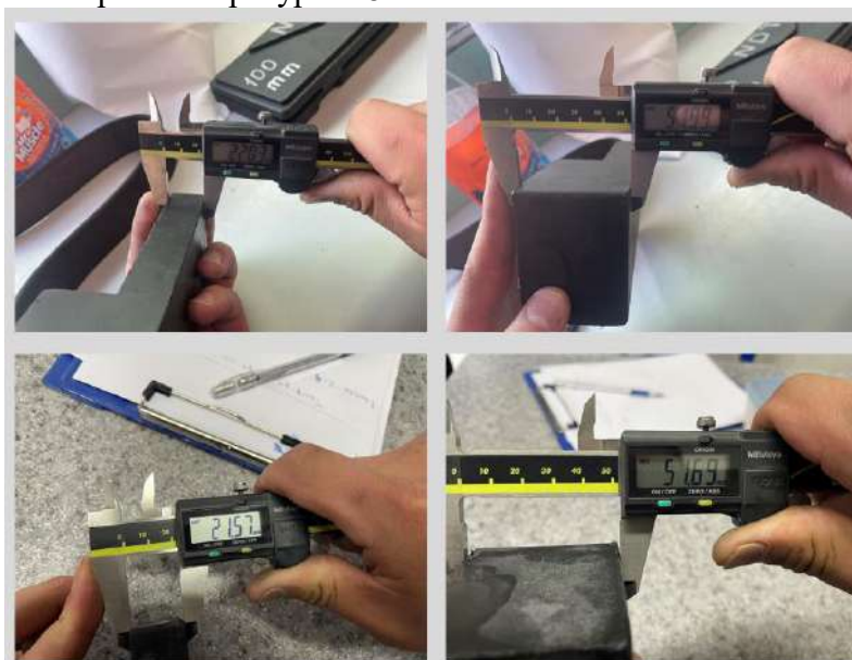
Рис. 4. Разница толщины полиэтилена после разницы температур.
