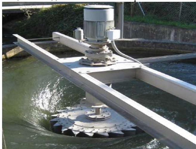
Рис. 2. Вихревая гравитационная гидроэлектростанция
