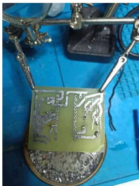
Рисунок 7 Лужение дорожек и монтаж платы
