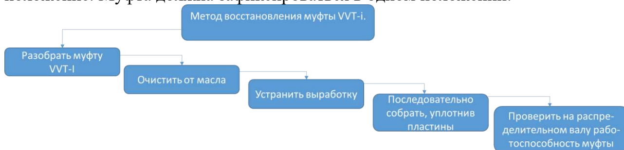
Рис 4. Восстановления муфты VVT-i
