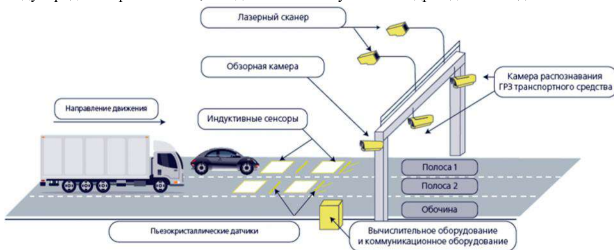
Рисунок 2 - Типовая система автоматического весогабаритного контроля
