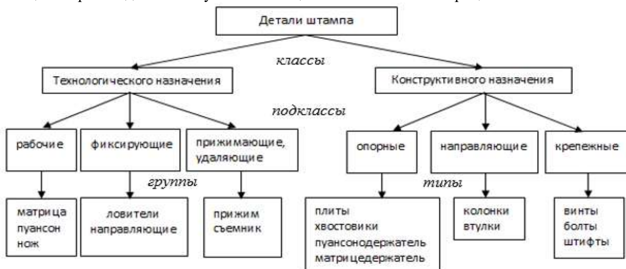
Рисунок 1. Классификация деталей вырубного штампа.
