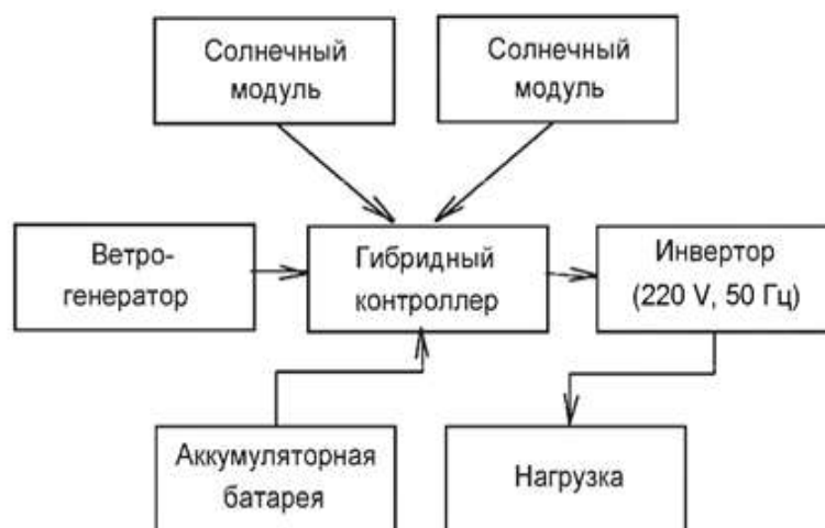
Рис.7. Функциональная схема автономной комбинированной солнечно-ветровой электростанции
