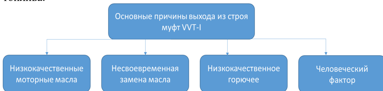
Рис 3. Основные причины выхода из строя муфт VVT-I
