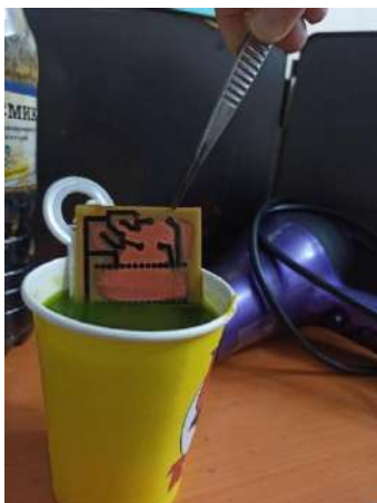
Рисунок 6 Травление платы хлорным железом
