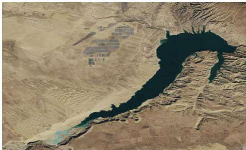
Рис.4. Расположение солнечных панелей и ГЭС проекта Лунъянся
