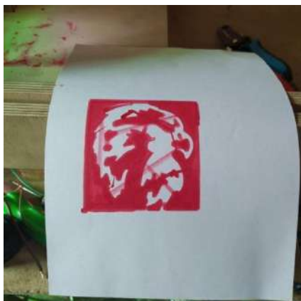
Рис. 5. Образец тестов точности управляющей программы маркером вместо фрезы.
