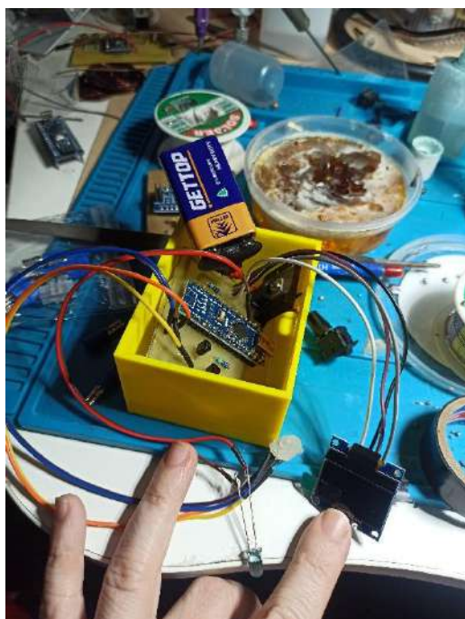
Рисунок 10 Окончательная сборка детского пульсоксиметра
