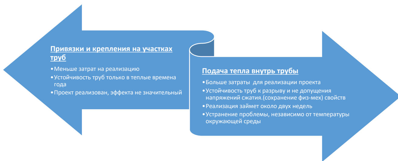
Рис. 5. Сравнительный анализ вариантов решения проблемы разрыва трубопровода.
