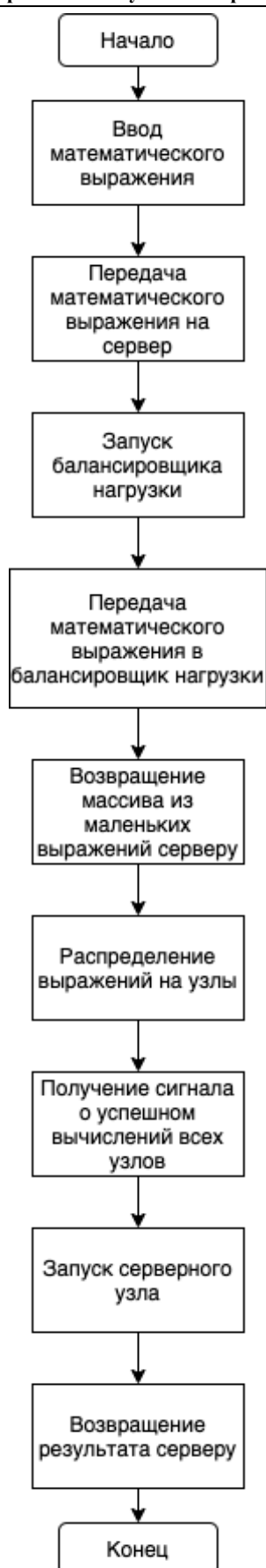
Рис 1.3 Структурная схема работы вычислительного кластера
