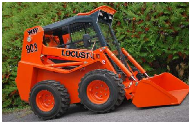
Рисунок 5. Мини –погрузчик для грузовых, земляных, уборочных работ.
