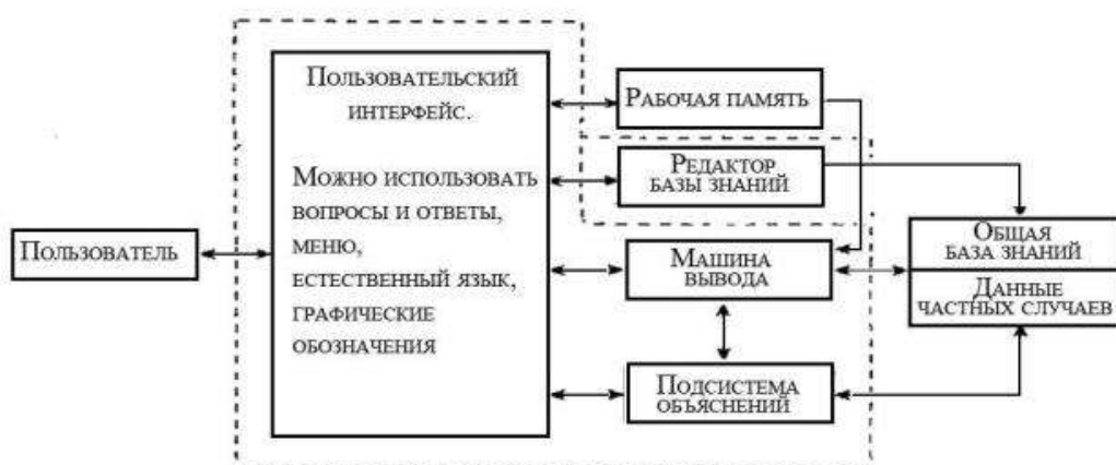
Рис.1. Схема работы ЭС
