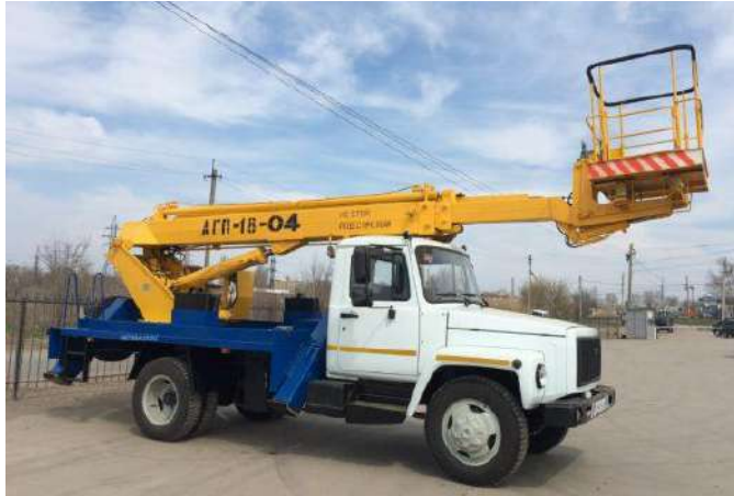
Рисунок 3. Автогидроподъемник с рабочей платформой АГП 18-04 на базовом шасси ГАЗ-3309.
