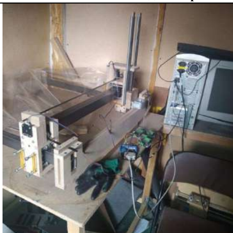
Рис.3. Трехосевой фрезерный станок с ЧПУ спроектированный и собранный.
