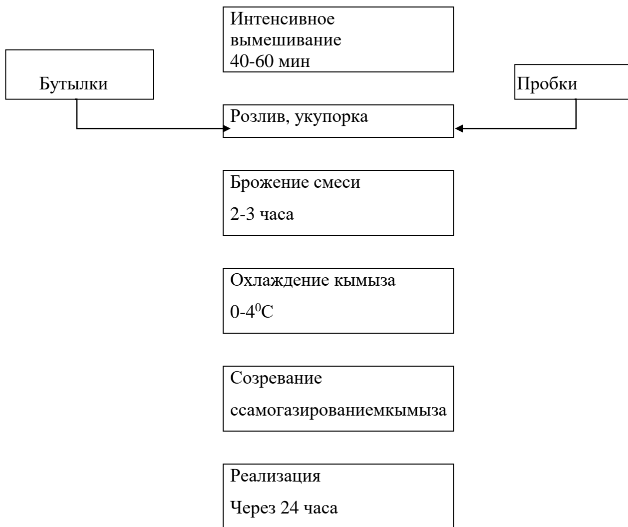
Рисунок 2 – Технологическая схема по ускоренному способу приготовления кымыза
