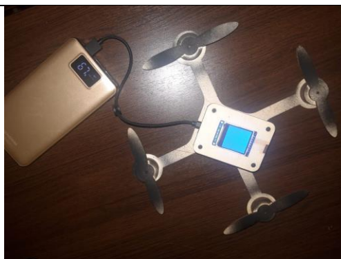
Рис.7 Подключение дрона к питанию.
