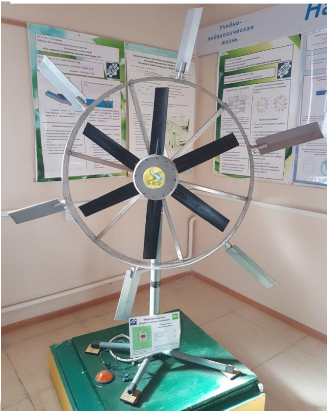
Бироторная ветро энергетическая установка мощностью 50 Вт
