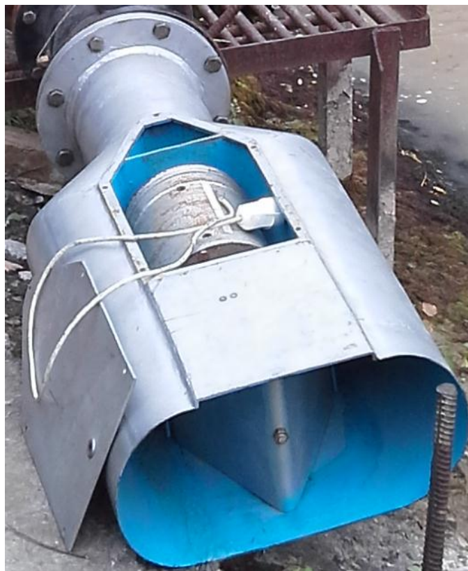
Бироторная микро ГЭС мощностью 1 кВт
