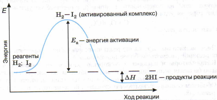
Рис. 15. Изменение энергии системы в ходе взаимодействия водорода и иода
