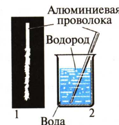
Рис. 32. Амальгмированная алюминиевая проволока: 1 — на воздухе; 2 — в воде
