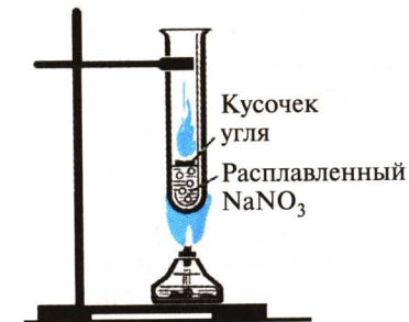
Рис. 16. Сгорание раскаленного угля в расплавленном нитрате натрия
