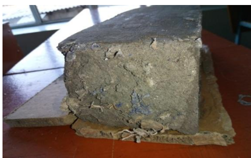
Рис.2. Кирпич на основе отходов текстильного производства.
