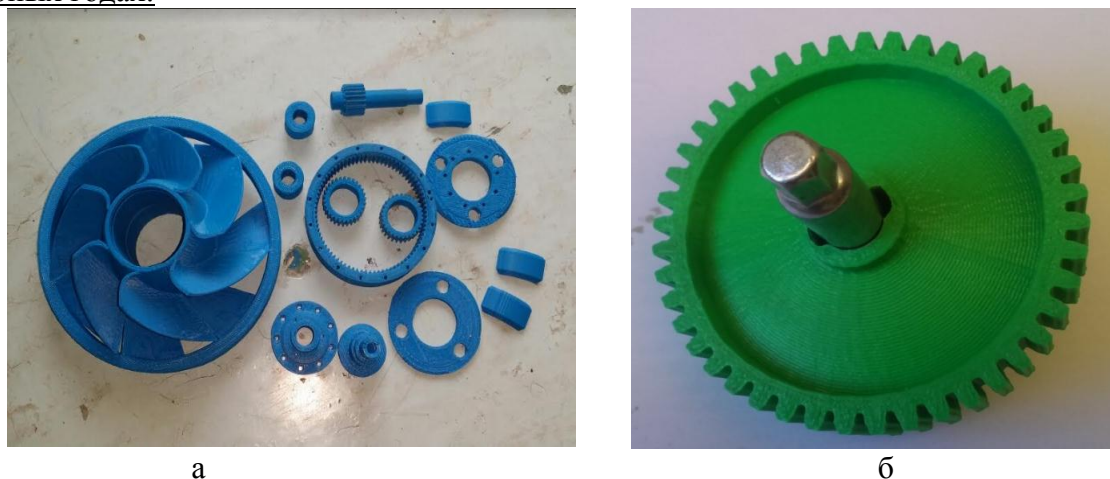
Рис. 9. Детали макета микрогэс (а) и ремонтного колеса мясорубки (б) [2, 3].
