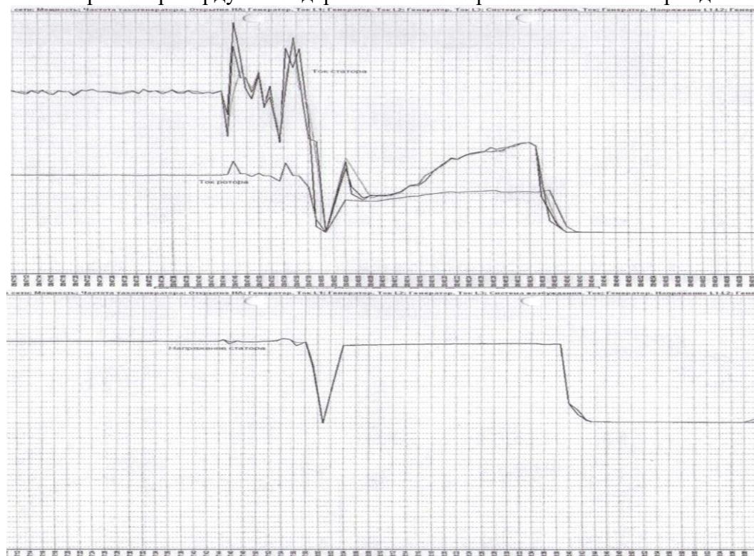
4-сүрөт. Эки машиналык системдеги статор жана ротордун агындарынын маанилери
