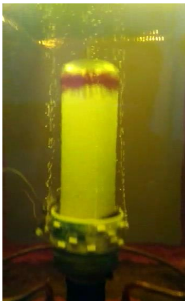
Рис. 1. Появление газоборазных пузырьков при межвитковом замыкании обмотке масляном трансформаторе на экспериментальном стенде.
