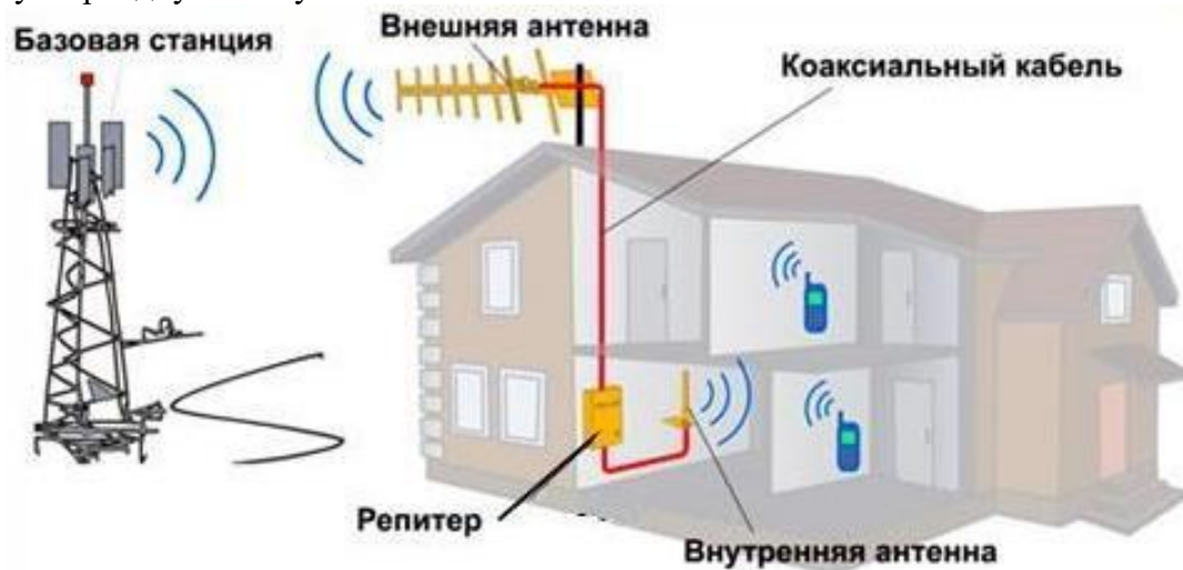
Рис 4. Подключение фемтосоты в частном доме
