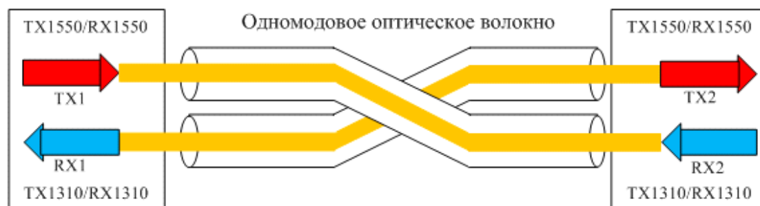
Рис.4. Линия с отдельными жилками.
