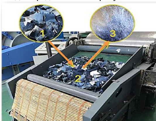
Рис.2. Оборудования для переработки текстильных отходов: 1-рубочная машина, 2-щипальная машина: пыльчатая и колкая, 3-разволокняющая машина с барабанами от 1 до 6. по объёме обработки 100кг/ч,150кг/ч,300-400кг/ч.
