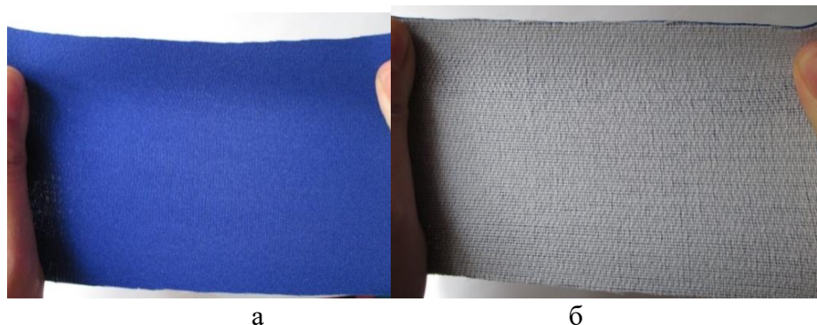
Рис.7 Исходный материал после дублирования термоклеевым прокладочным материалом со схожими показателями растяжимости (а – лицевая сторона, б – изнаночная сторона)
