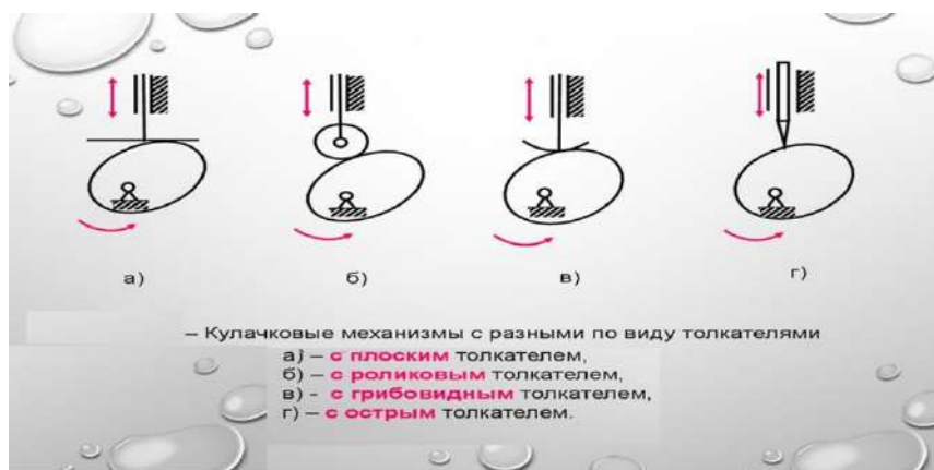
Рис.1. Виды кулачковых механизмов:
