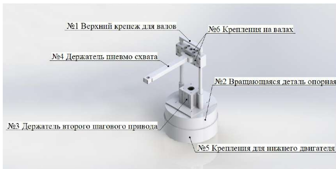
Рис.6 Сборка манипулятора
