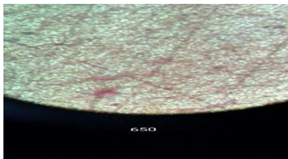
Рис.9. Образец нагретый до 650°C в оптическом микроскопе
