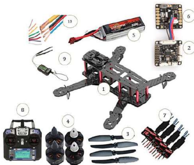
Рис.1. Конструкция квадрокоптера: 1-рама и лучи; 2-полетный контроллер; 3-винты; 4-моторы; 5-акб; 6-плата распределения питания; 7-регуляторы скорости; 8-пульт радио управления; 9-радио-приемник; 10-комплект проводов
