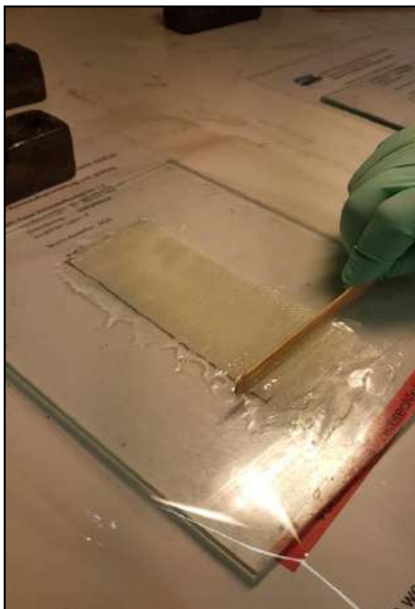
Abb.1) benetzen der Faser mit einem Holzstab Zugversuch
