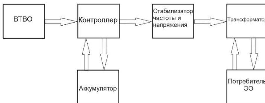
Рис.4. Блок-схема передачи выработанной электрической энергии.
