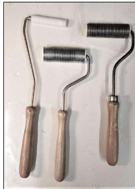
Abb. 2) Rollen zum Beseitigen von Luft einschließen
