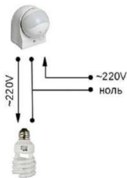
Рис. 2. Схема подключения датчика движения
