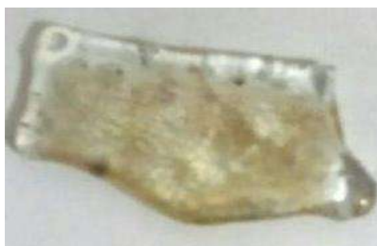
Рис.20. Внешний вид образца нагретого до температуры 650°C
