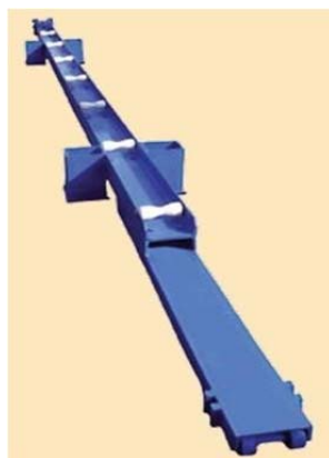
Рис. 1. Вид укладочной рамы РСТ-6000 компании «Бури́нтех» для спуска керн со стола ротора [1]
