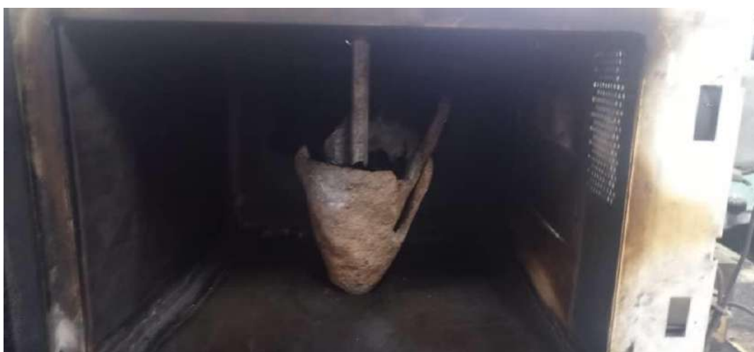
Рис.3. Фотография резонаторной камеры и реакционной установки
