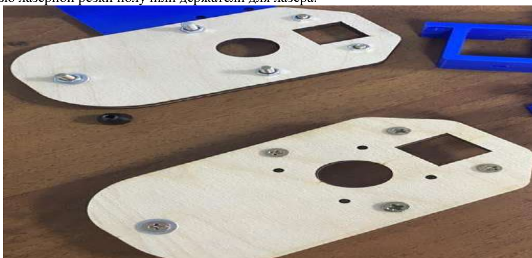
Рис. 2. Держатели для лазера с помощью лазерной резки
