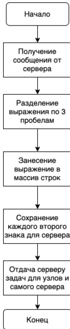
Рис 1.2 Структурная схема работы балансировщика нагрузки
