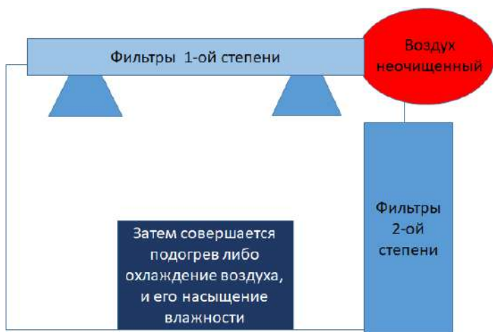
Рис.1. Составные модули подачи очищенного воздуха
