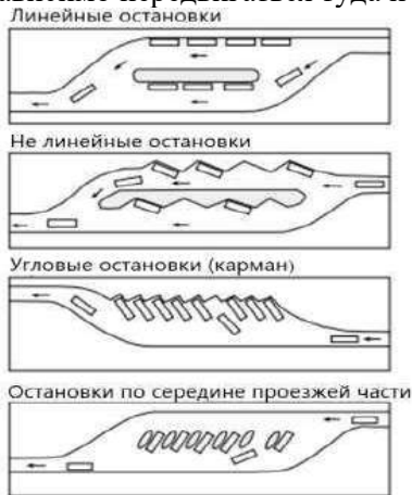
Рис. 2. Схема зон посадки/высадки пассажиров (Линейные остановки, не линейные остановки, угловые остановки (карман), остановки по середине проезжей части)
