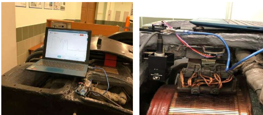
Рис. 4. Экперимент измерения износа щётки с помощью датчика присоединенного к микроконтроллеру Ардуино
