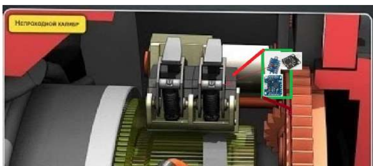
Рис. 2 Визуальное изображение крепления герметичного корпуса с датчиком к траверсе и щёткодержателю
