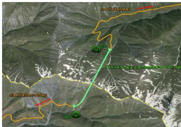
Рис 3. Северный и южный портал Автодорожного тоннеля
