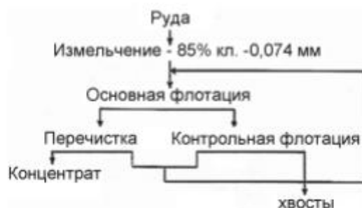
Рис.1. Технологическая схема флотационного обогащения
