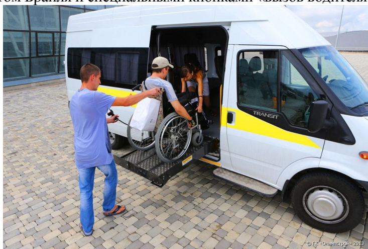
Рис. 2 Специализированные транспортные средства, оборудованные механизмом подъема кресел-каталок, табло со шрифтом Брайля и специальными кнопками «вызов водителя»
