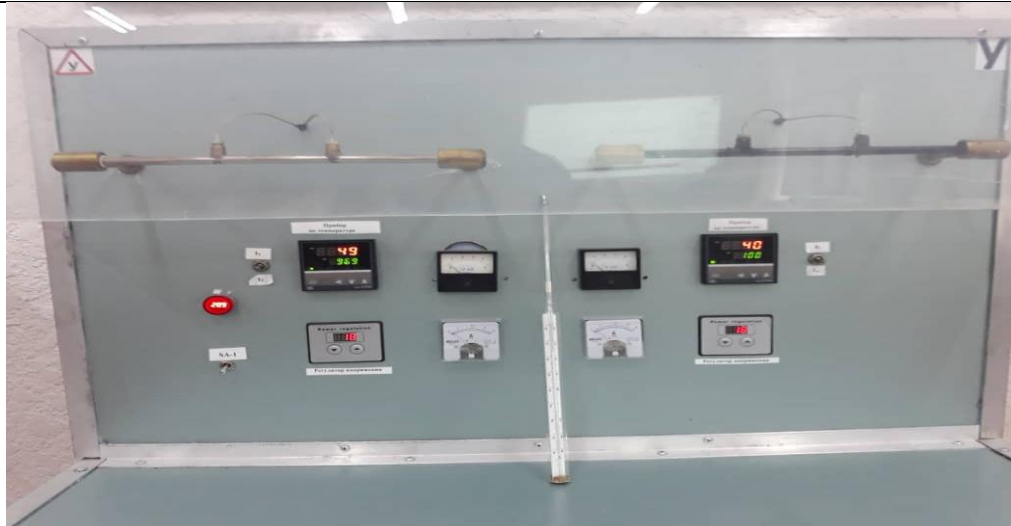
Рис.1. Экспериментальный стенд для определения степени черноты горизонтальных трубок при естественной конвекции
