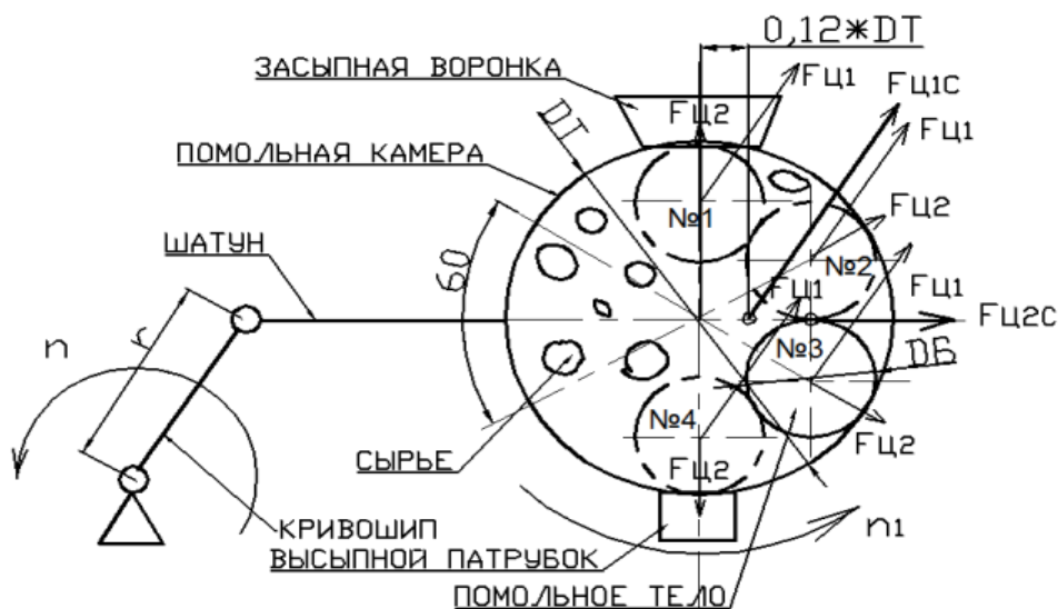
1-рисунок Принцип работы мельницы
