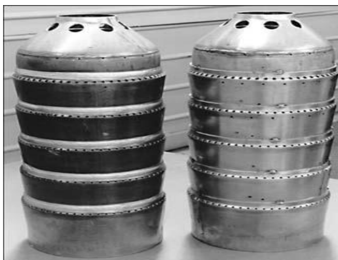
Рисунок 2 - Жаровая труба ТРД ДН-80 с 5 кольцевыми сварочными швами.
