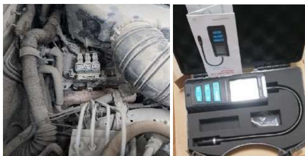
Рисунок 2. – Проверка на утечку газа детектором «Mestek CGO-2».
