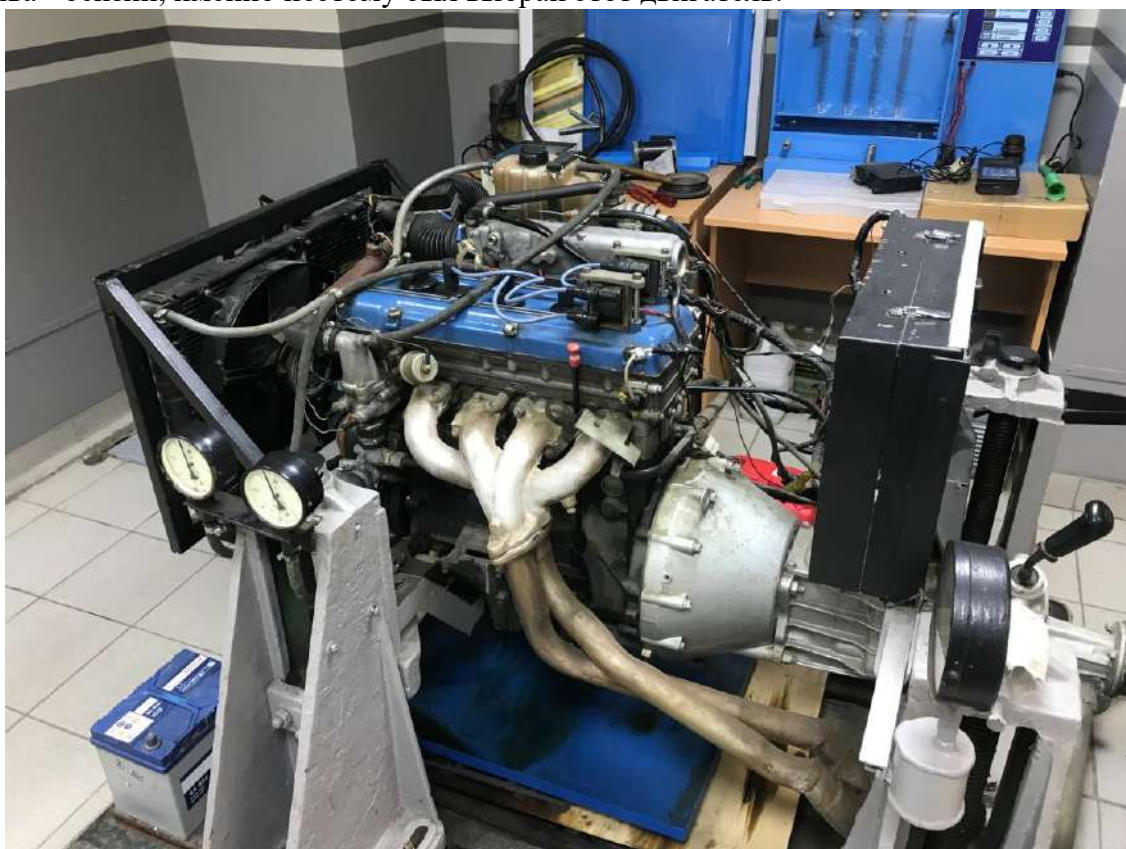
Рис. 5. Экспериментальная установка на базе двигателя ЗМЗ-4062.10
