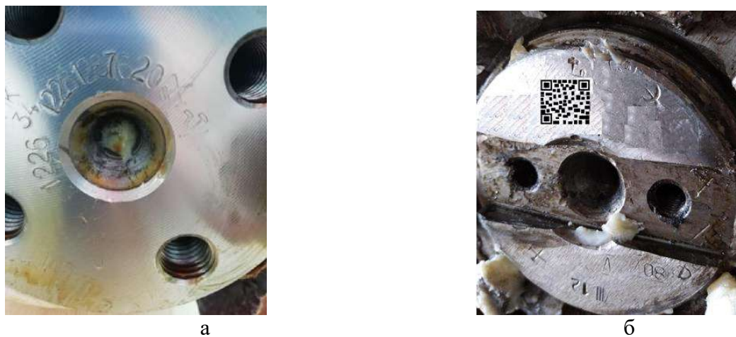
Рисунок 3 – Торец оси колесной пары: а - изготовления 2020 года; б - фотомакет со специализированным qr-кодом.
