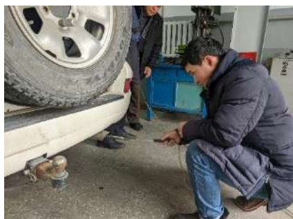
Рисунок 1. – Установка зонда для замера отработавших газов.
