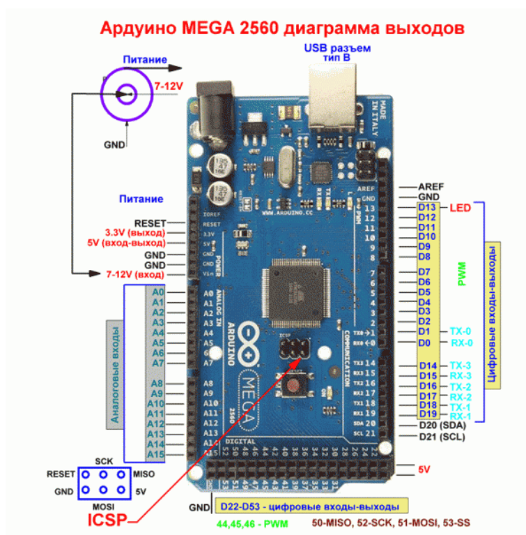
Рис. 1.2. распиновка входов/выходов Arduino MEGA 2560
