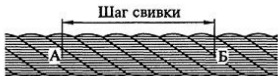
Рис.3. Определение шага свивки шестипрядного каната
