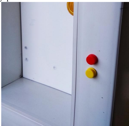
Рис 8. Тактовые кнопки. Красная–кнопка закрытия; желтая–кнопка открытия.
