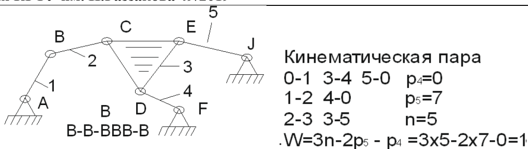
Рис. 1. Одной механизмом образованной с использованием группы Бурместера
