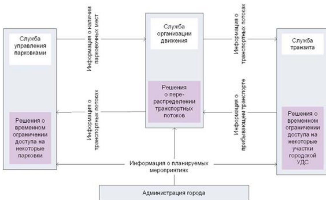
Рисунок 2 - Схема информационного обмена между некоторыми модулями ИТС
