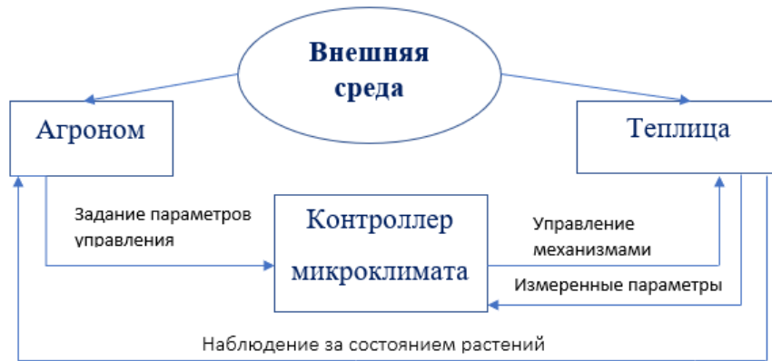
Рис. 1. Структура традиционной системы управления теплицей
