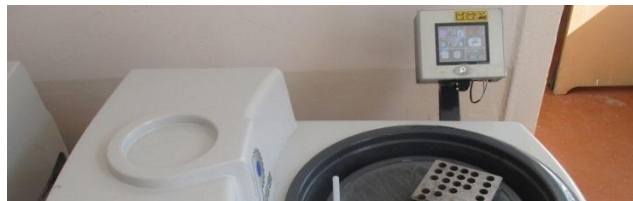
Рис.2. Minitech 233– ручная однодисковая шлифовально-полировальная машина с варьируемой скоростью вращения.
