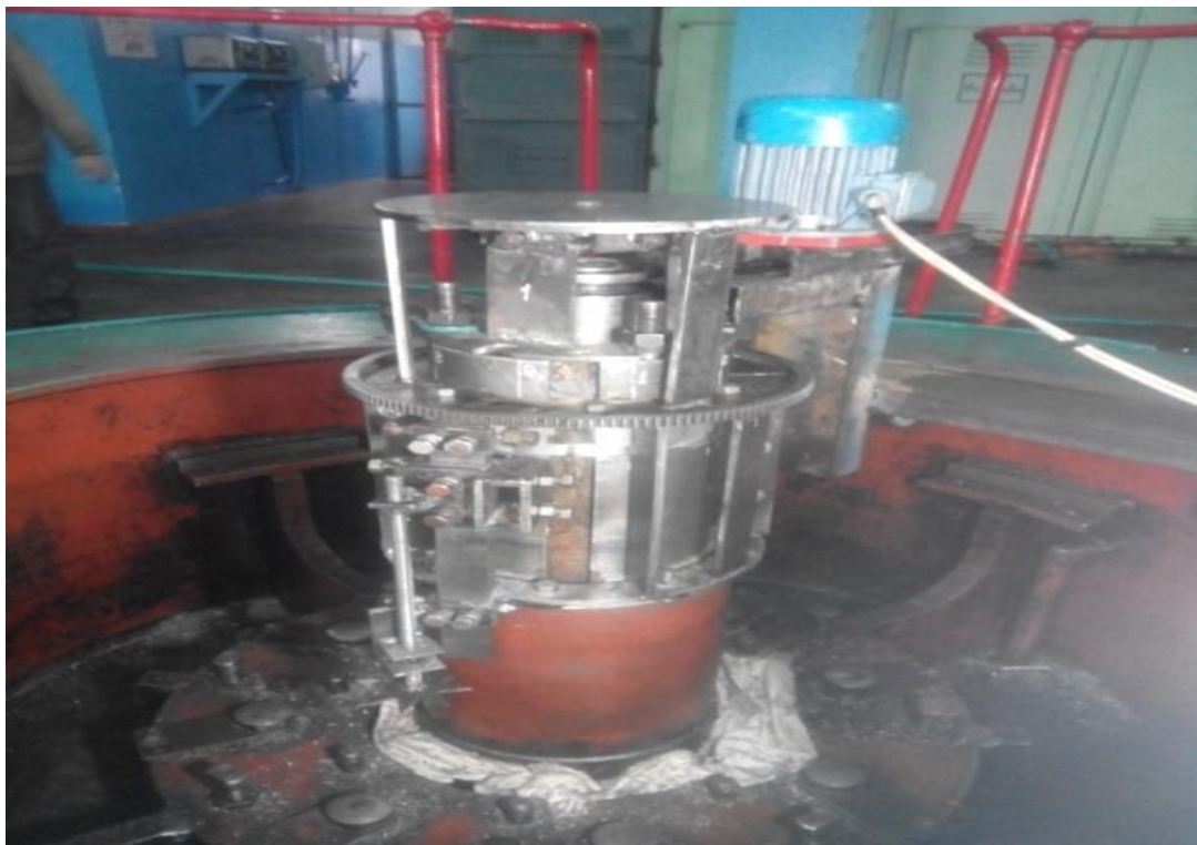
Рис. 4. Универсальный переносной станок для проточки генераторного вала
